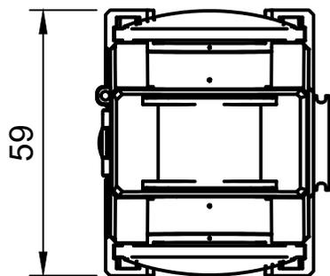
Der Kabelumbauwandler besteht aus zwei Kernhälften, von denen – je nach Ausführung – eine oder beide die Sekundärwicklung tragen.
