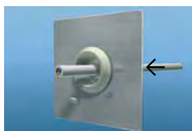
Führen Sie das Kabel durch die Dichtungsdurchführung. Pierce the grommet with the cable.
